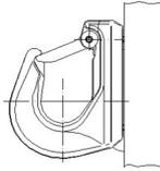
Anschweißhaken nach dieser THIELE-Werksnorm (TWN) sind zum Heben und Bewegen von Lasten vorgesehen und werden vornehmlich an Erdbaumaschinen, z.B. an Schaufeln, angeschweißt.
