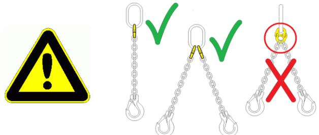
Werden zwei Kettenstränge in einer Verbindungsgliedhälfte für den wechselseitigen Gebrauch der Stränge montiert, darf ausschließlich nur ein Kettenstrang belastet werden!
